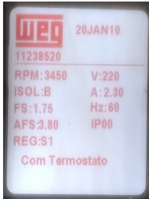
Figura 3.38 – Placa de identificação do motor da motobomba.
