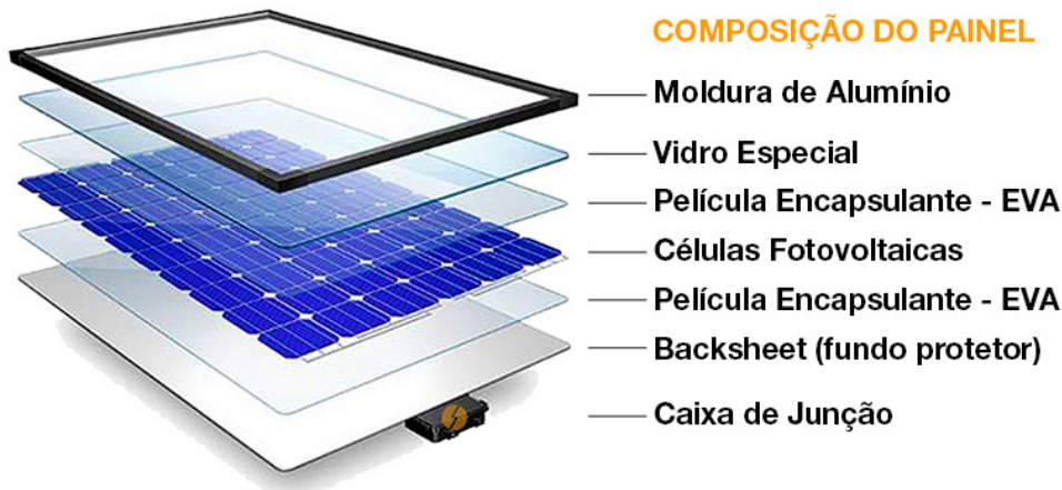
Figura 3.16 – Características construtiva dos módulos PV.
