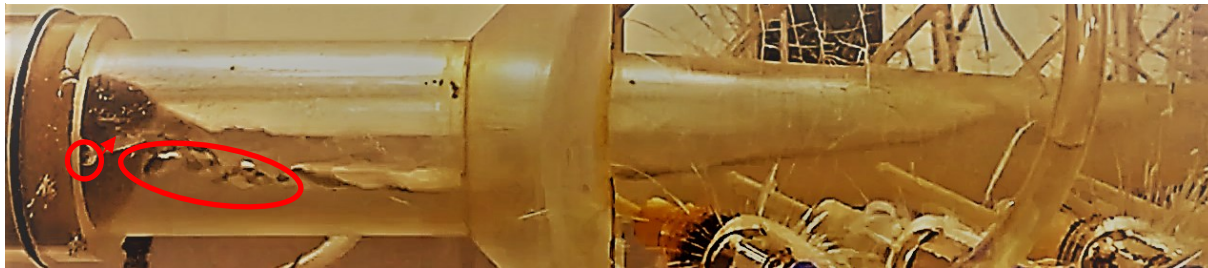
Figura Q. 14 Zonas de recirculação na saída do venturi para o padrão estratificado.
