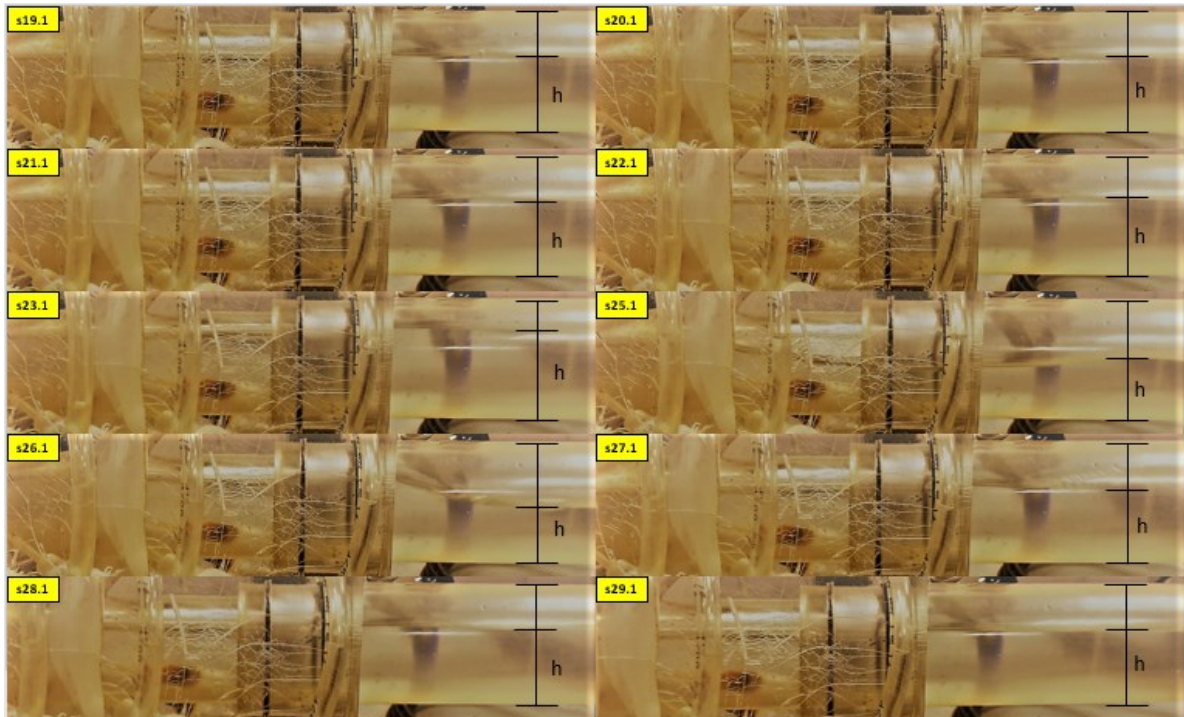
Figura 4.15 Efeito do padrão pistonado na altura de coluna de líquido, h , na entrada do Venturi.
