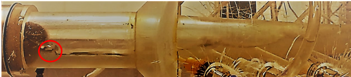
Figura Q. 11 Zonas de recirculação na saída do venturi para o padrão estratificado.
