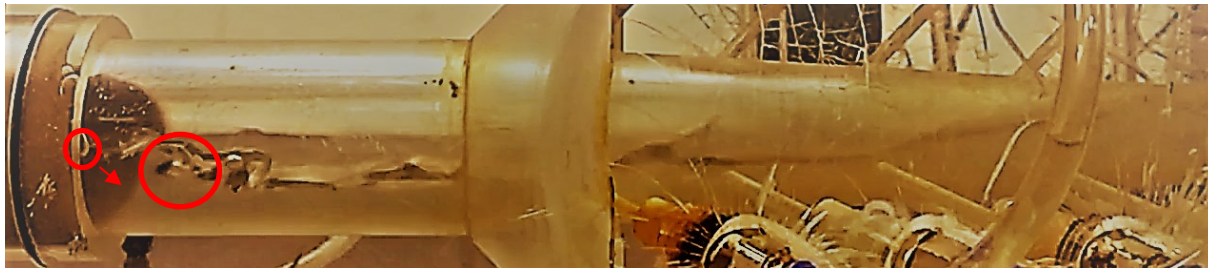
Figura Q. 13 Zonas de recirculação na saída do venturi para o padrão estratificado.
