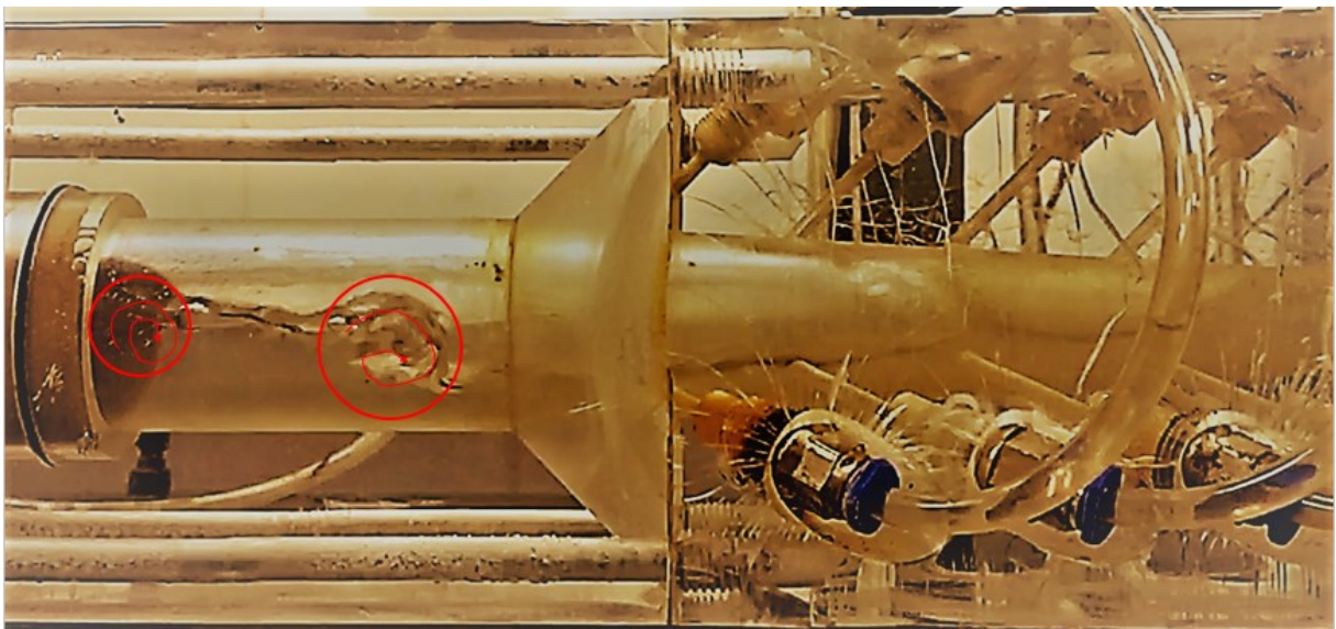
Figura 4.9 Efeito da singularidade no escoamento bifásico à jusante do Venturi. Duas zonas de recirculação são destacadas. Escoamento ocorre da direita para a esquerda.
