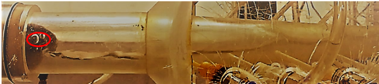
Figura Q. 8 Zonas de recirculação na saída do venturi para o padrão estratificado.
