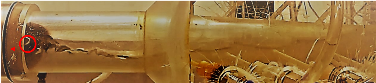
Figura Q. 16 Zonas de recirculação na saída do venturi para o padrão estratificado.
